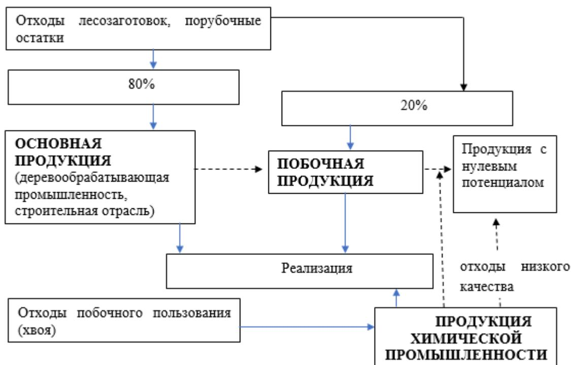
Рисунок 2 - Схема использования отходов основного производства предприятия
